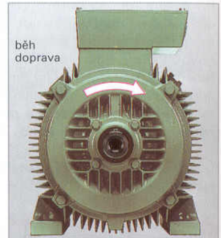
Obr. 3 Určení směru otáčení motoru
